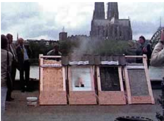
Das Sparrenfeld mit Polystyrol brennt zuerst durch
